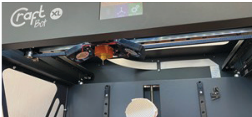
8. ábra: 3D-s nyomtató – PLA filament extrudálás. Forrás: saját forrás
