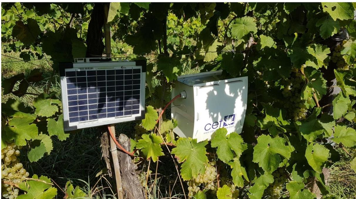
Figura 27. WTrap, un'innovativa trappola per insetti sul campo
