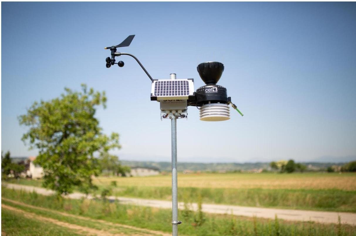
*Figura 17. Stazione meteorologica con più sensori sul campo*
