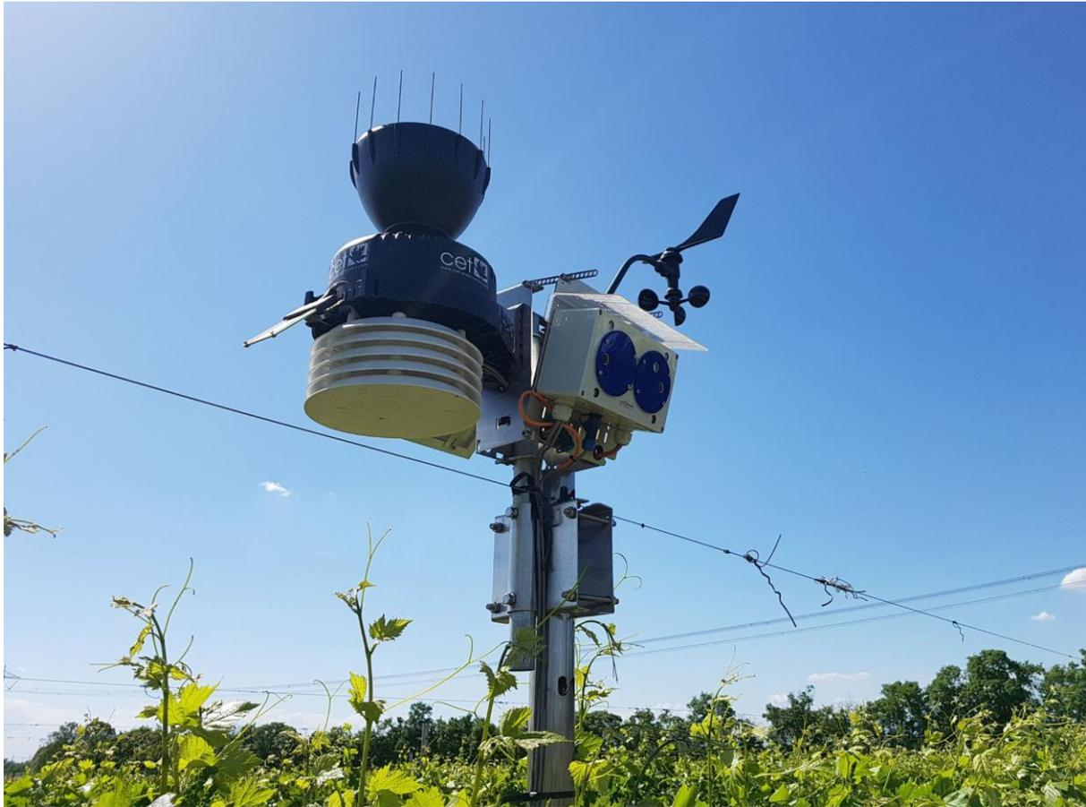
*Figura 26. Stazione meteorologica dotata di telecamera stereo*
