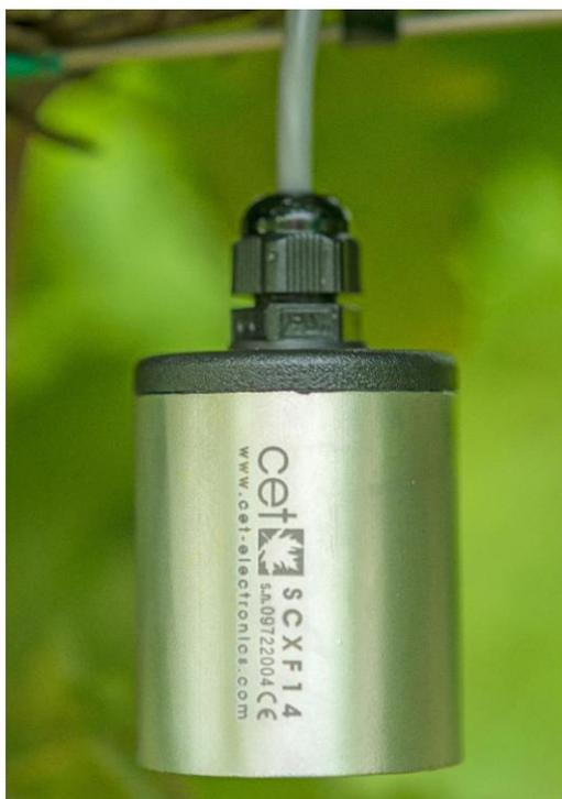
*Figura 22. Sensore di temperatura e umidità dell'aria all'interno della chioma*
