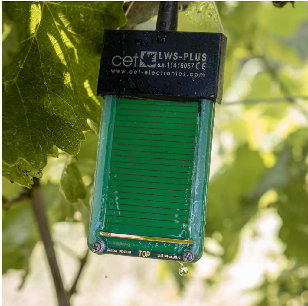
*Figura 23. Sensore di bagnatura delle foglie e di gocciolamento dell'acqua*
