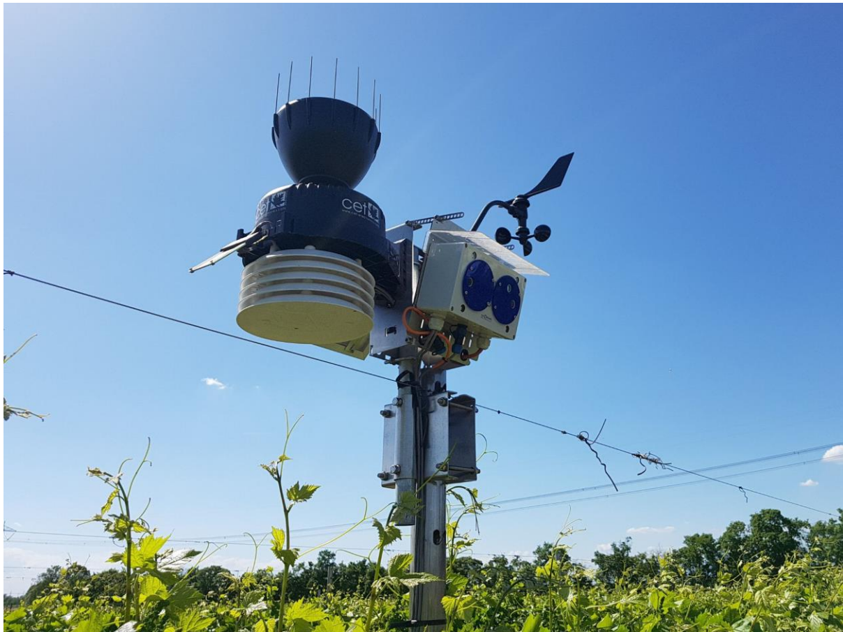
26. ábra Sztereokamerával felszerelt időjárás-állomás
