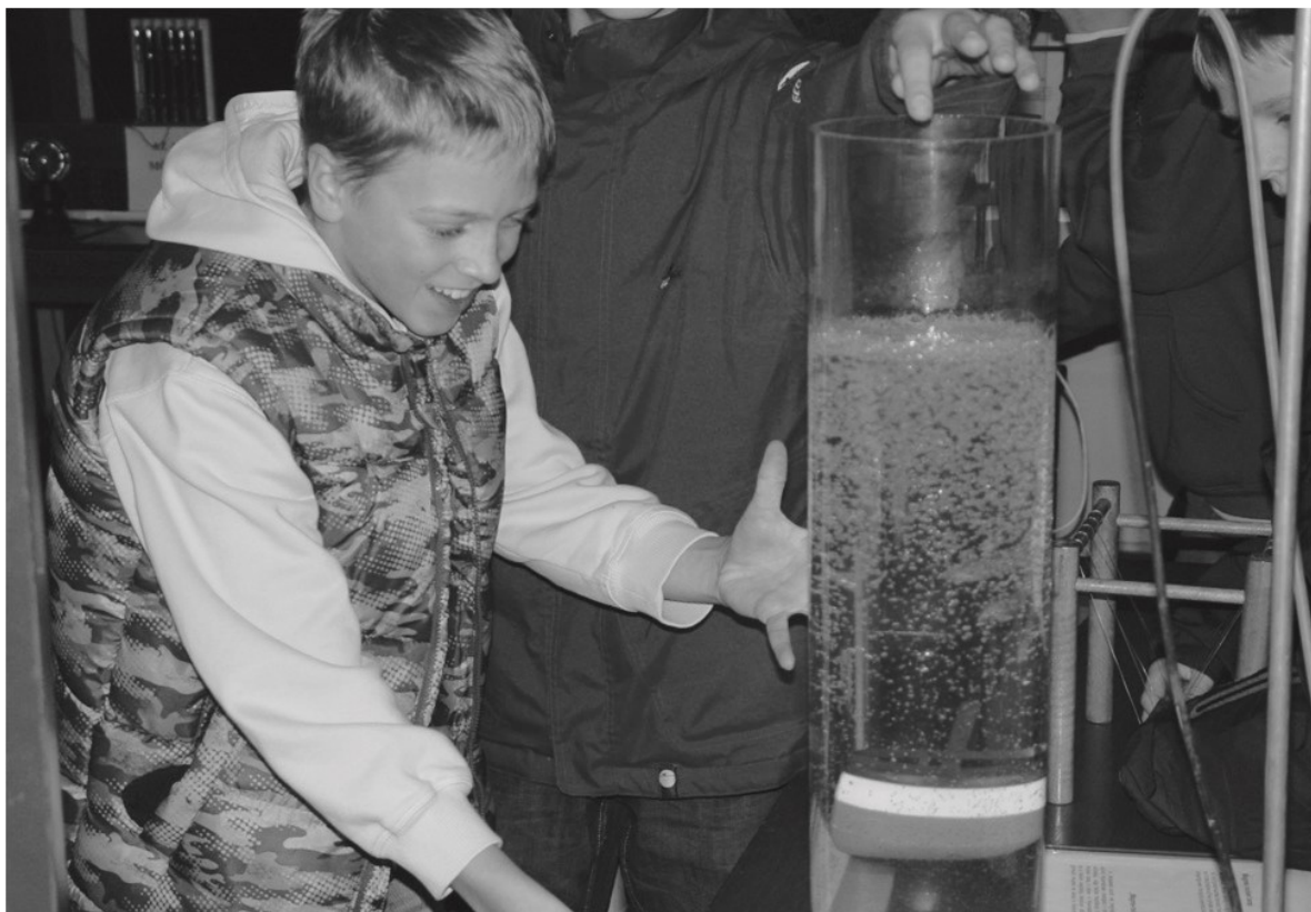
4. ábra: A Bermuda-hengerben elsüllyed a kis hajó. Egy feltételezés szerint ennek az óceán mélyén levő vulkánok az okai, amelyekből kitörő gázok lecsökkentik a víz felhajtóerejét. E feltételezés azonban kevéssé valószínű, mert ott nincsenek törésvonalak, illetve e mechanizmusnak másutt (is) katasztrófákat kellene okoznia, ha elég erős volna.
