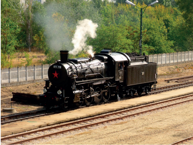
3. kép: Az Egyesült Államoktól 1947-ben beszerezett USATC S-160 típusú, a MÁV-nál 411. sorozatú gőzmozdony (Forrás: a szerző felvétele)
