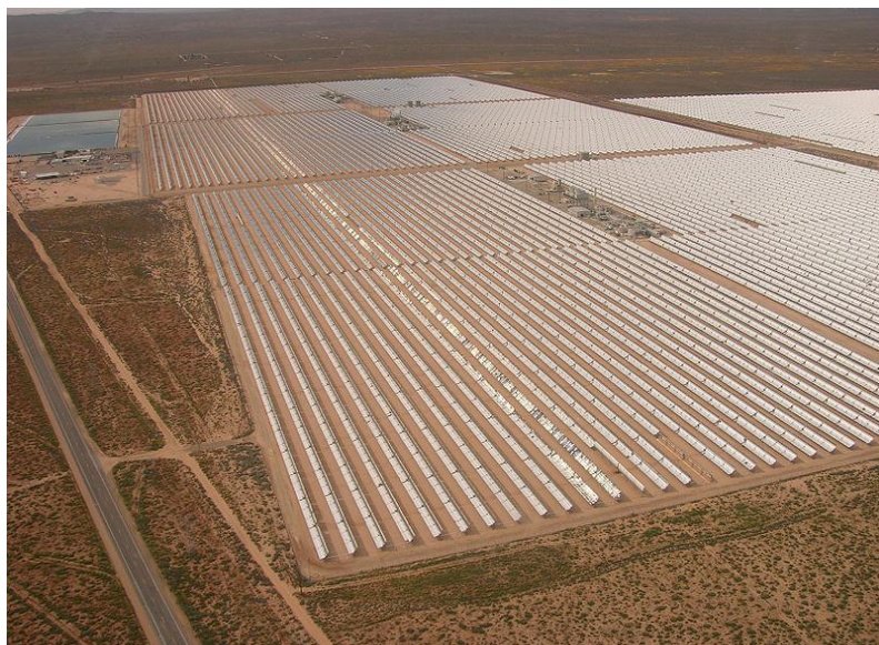
20. ábra: Egy parabola-vályús (vonalfókuszos) erőmű távlati képe
